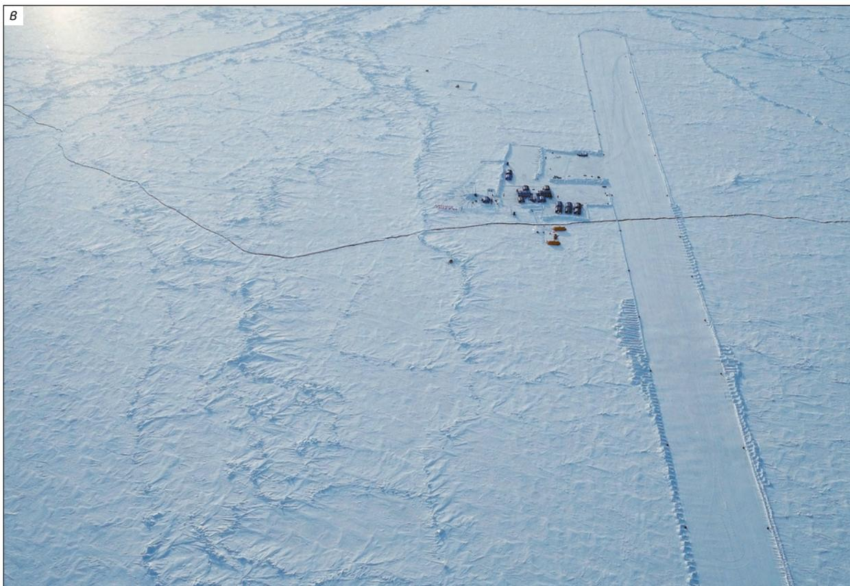
Аэродромы на ледовой базе «Барнео» 5-го (а), 9-го (б) и 14-го (в) апреля 2016 г. Каждая взлетно-посадочная «полоса» после ледового торошения при прохождении трещины строилась заново.
